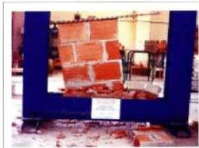
Photo 2 : Mode de rupture du muret en brique de terre cuite ( $\theta = 90^\circ$ )
